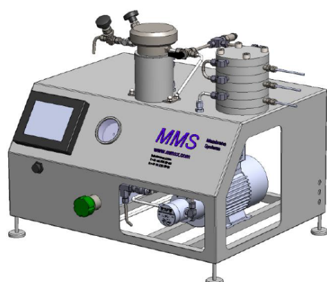
Figur 7: Forsøksoppsett for rensing av saltlake
